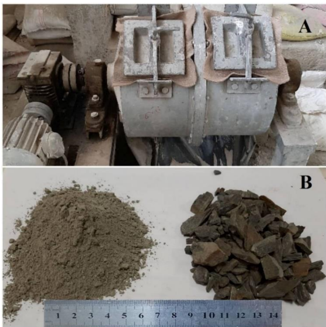
شکل ۶: مراحل سایش سنگ اسلیت-فیلیت (A) دستگاه لس آنجلس (B) پودر حاصل
